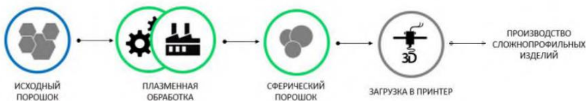
7-сурет. Стандартты металл ұнтақтардың плазмалық сфероидизациясын пайдалана отырып, аддитивті технологиялармен күрделі бейінді бұйымдарды алудың технологиялық схемасы
